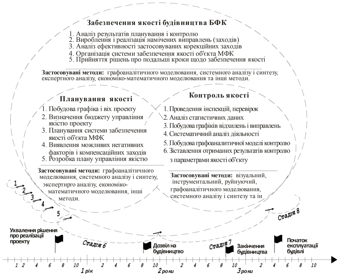
Рис. 3.8. Модель забезпечення якості будівництва об'єктів БФК
