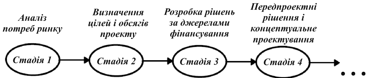
Рис. 2.3. Послідовність реалізації будівельного проекту
