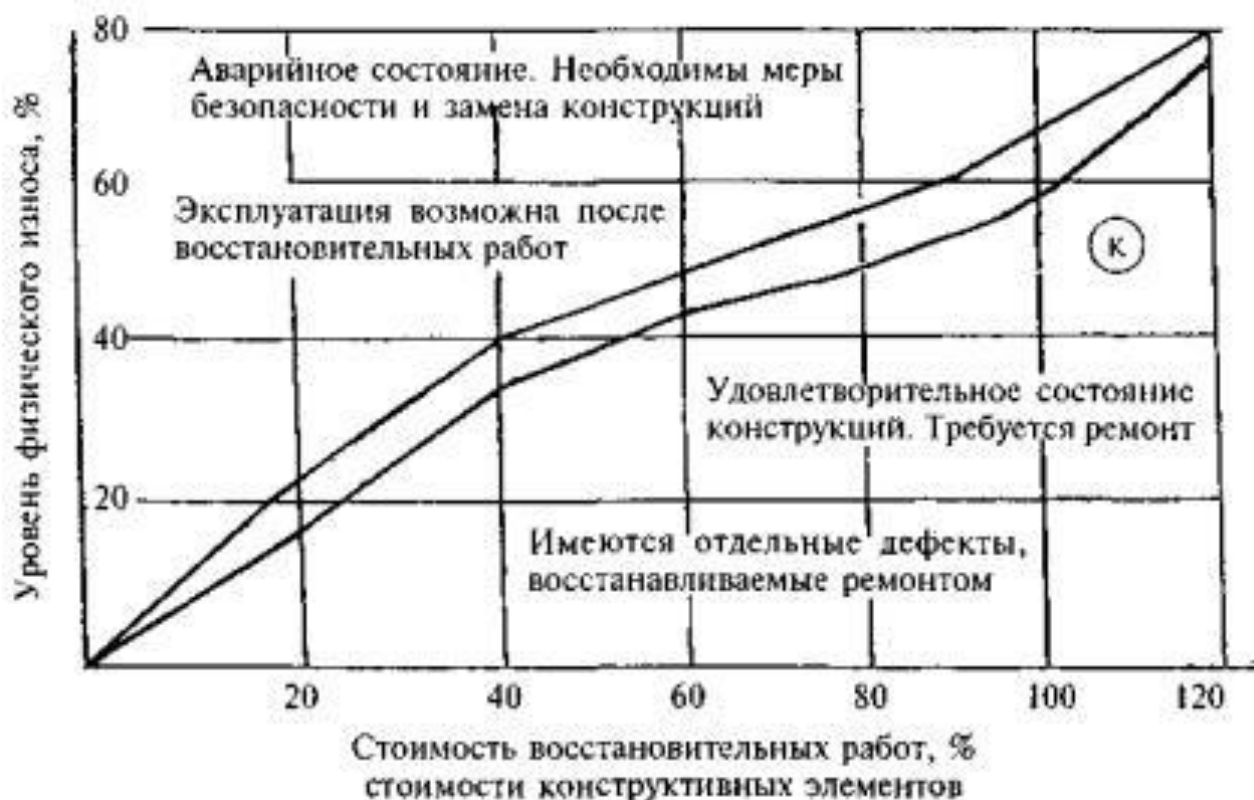
Рис. 1.1 Взаимоотношение уровня физического износа конструктивных элементов и здания в целом и стоимость восстановительных работ
