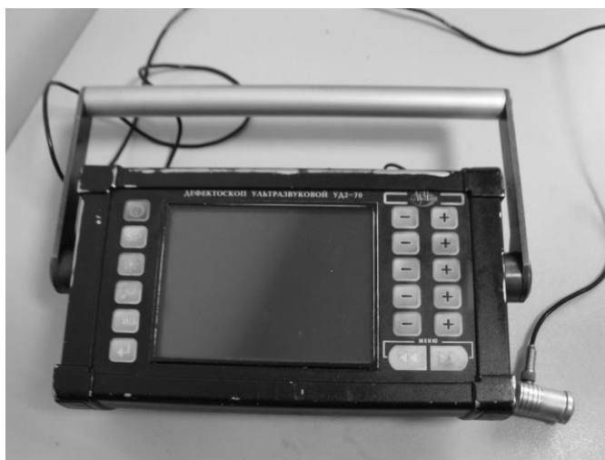
Рис.2.15 Ультразвуковой дефектоскоп УД2-70
