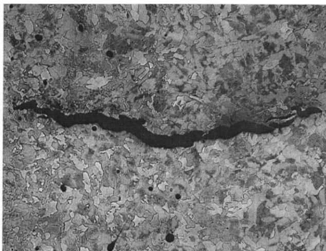
Рис. 3.11 Общий вид трещины в оси № 98765 плавки 0261828
