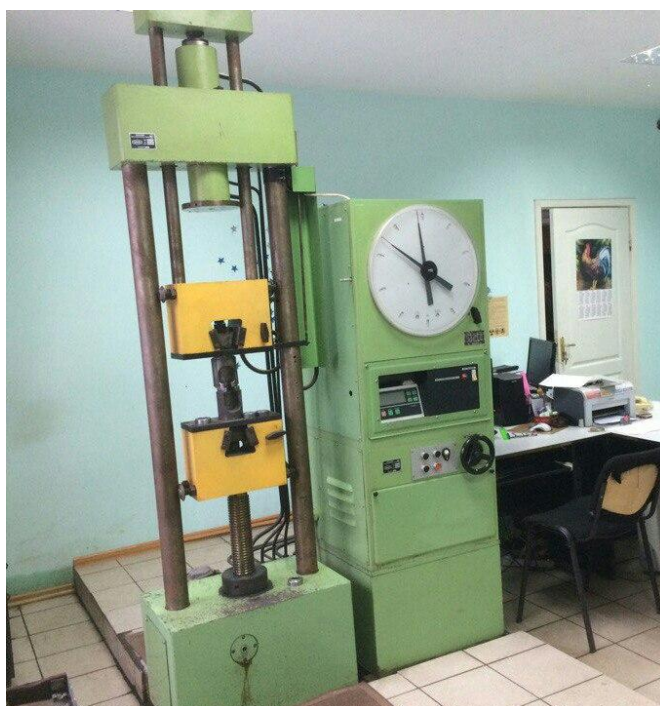
Рис. 2.7 Разрывная машина Р-10 для испытания образцов на растяжение
