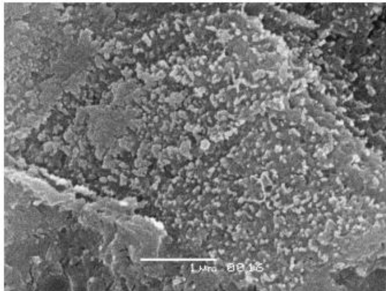
Рис. 2.20. Мікрофотографії характерних ділянок відколу цементного каменю з комплексним органомінеральним модифікатором (Ц-МБ-В) \times 25000
