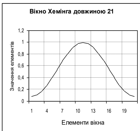
Рис. 5.7. Вікно Хеммінга для обробки ФНЧ
