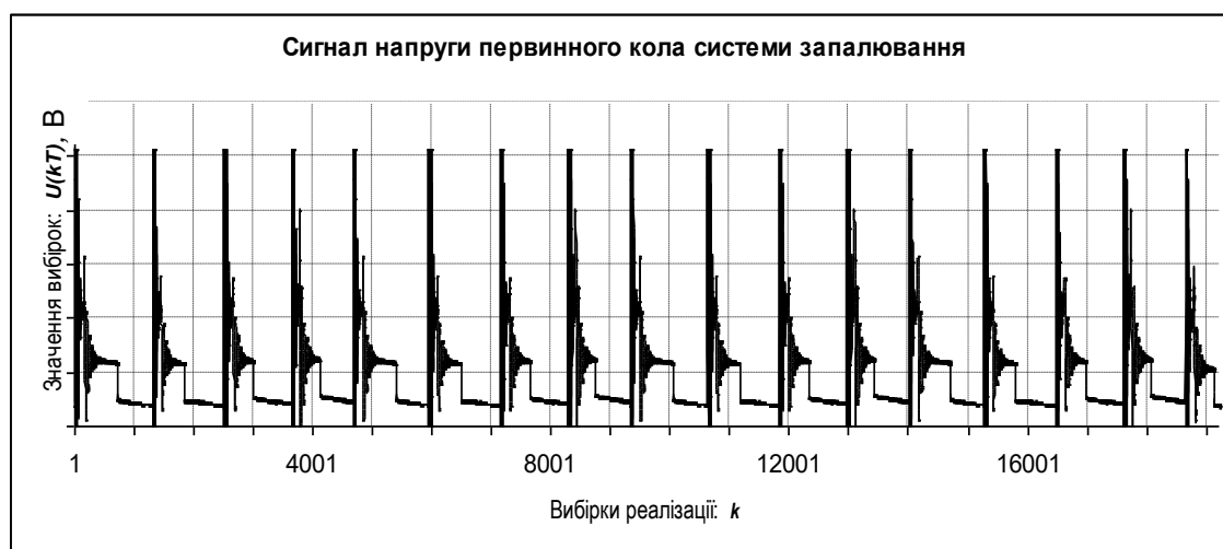
Рис. 5.2. Сигнал напруги первинного кола системи запалювання
