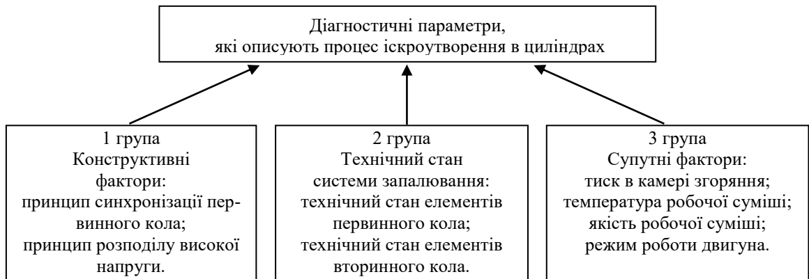
Рис.2.3. Фактори, які впливають на діагностичні параметри системи запалювання
