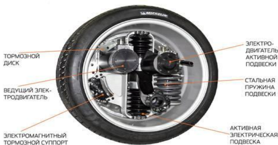
Мал. 1.4 Схема електричного мотор-колеса компанії Michelin.
