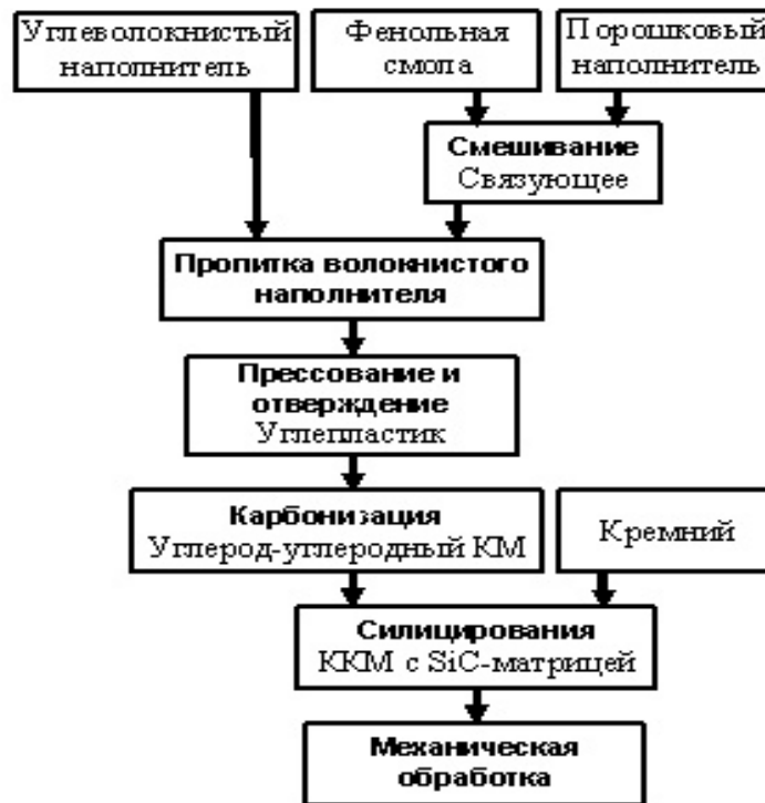
Рис. 1.3. Схема процесу ущільнення каркаса жидкофазним методом
