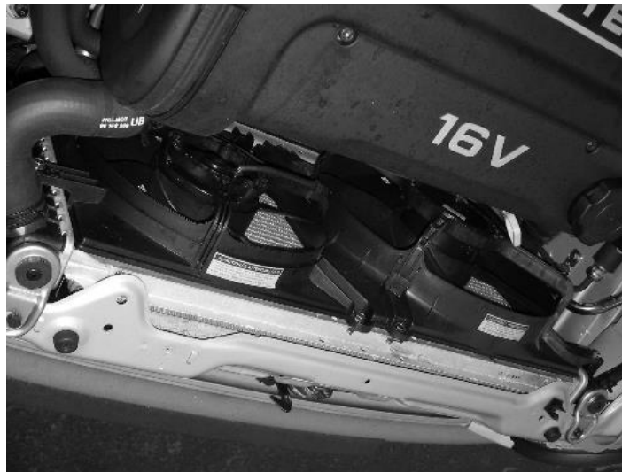
Рис. 1.7 Система охолодження автомобіля Daewoo Lanos
