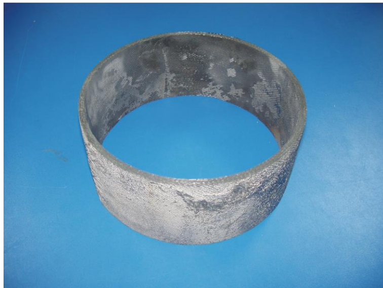
Рис. 3.7. Зовнішній вигляд кільця з вуглець-вуглецевого матеріалу після механічної обробки
