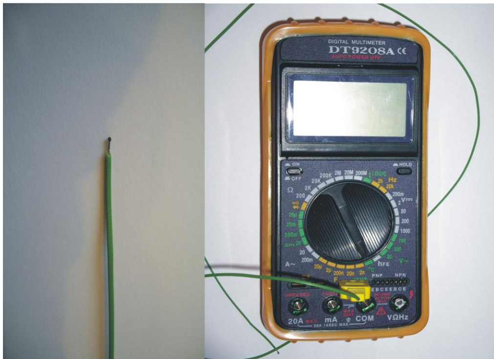
рис. 4.9. Таріровка термопар за допомогою електронного вимірювального приладу DT9208A
