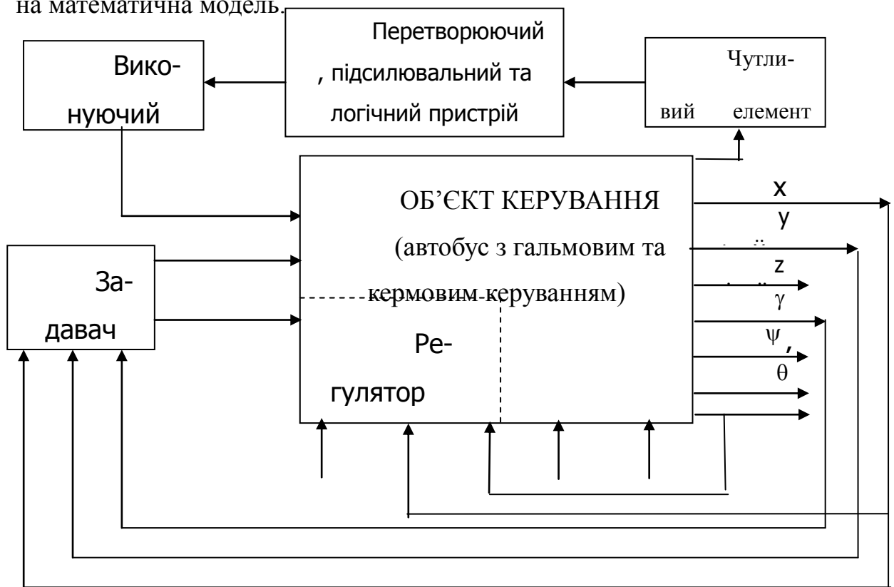
Рис. 2.1. Узагальнена функціональна схема АБС автобуса
