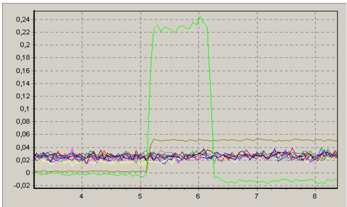
Рис. 7.15. Графік гальмування махової маси стенда при P=4,5 \text{ МПа} , n=1850 \text{ с}^{-1}
