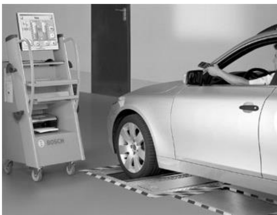
Рис. 2.3. - Діагностика гальмівної системи на стенді ЛТК-3П-СП-11
