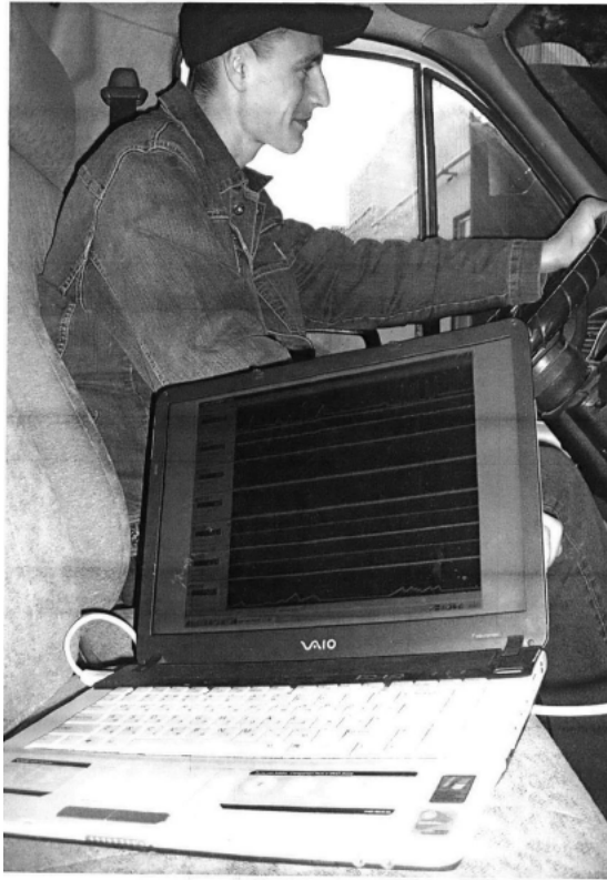
Рис. 3.6. Зняття даних за допомогою діагностичного комплексу «Мотор-тестер»
