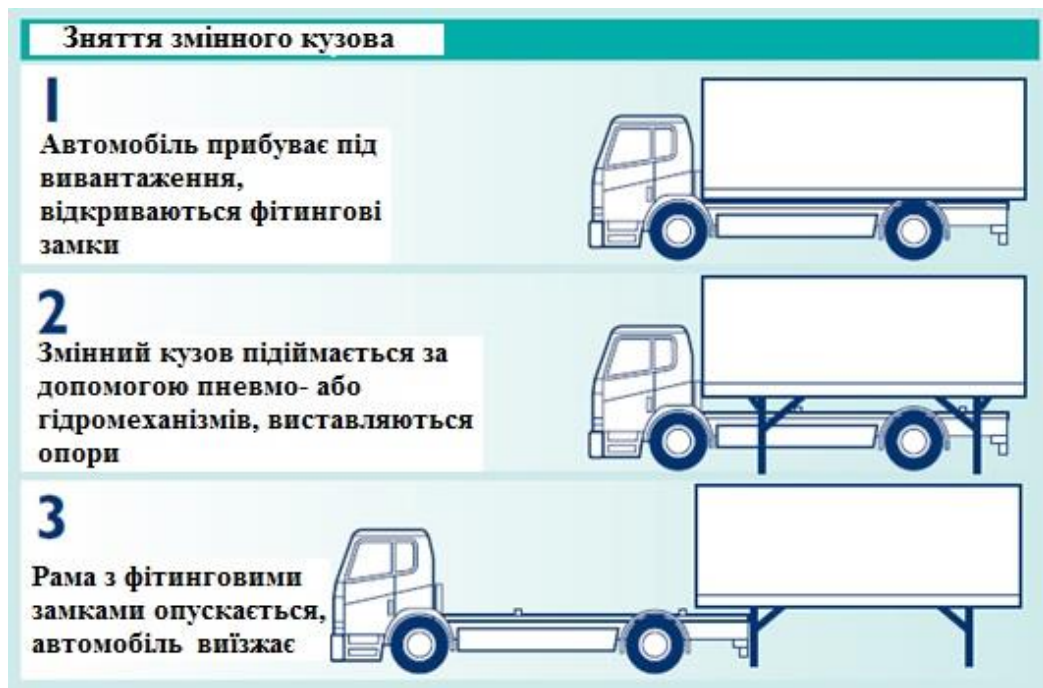
Рисунок 1.2 - Технологія зняття змінного кузова
