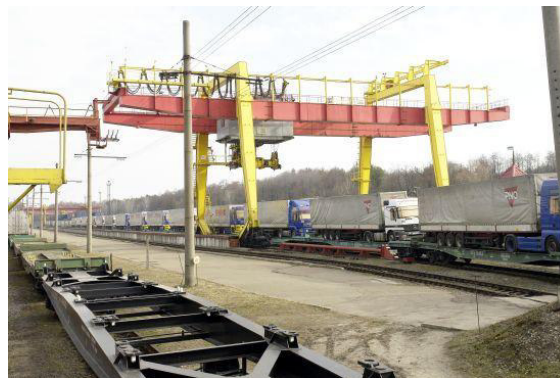
Рис. 1.2. Контрейлерні перевезення на спеціалізованих платформах:
