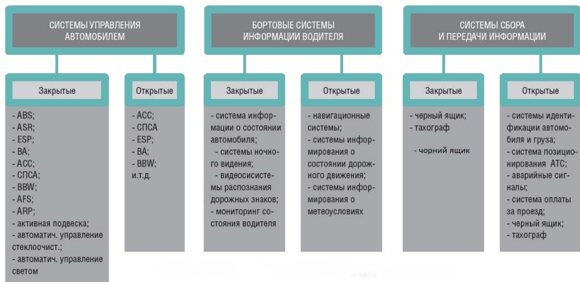
Рис. 1.3 - Блок-схема класифікації бортових систем інтелектуального автомобіля
