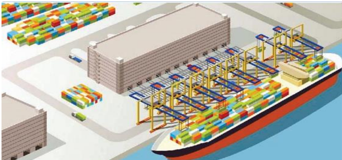
Рис.1.11 Макет автоматизованого контейнерного висотного складу системи UCW
