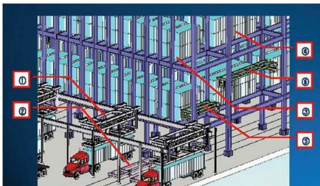
Рис. 1.8 Технологічні елементи висотного стелажного складу: 1 – мостовий кран; 2 – автоматична тележка; 3,4 – елементи для контейнера; 5,6 – ліфти-спредери.
