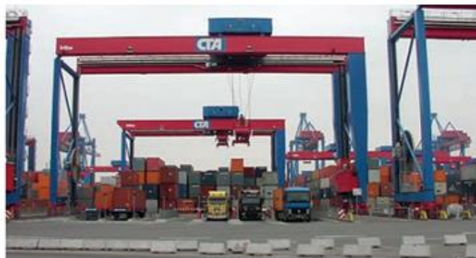
Рис. 1.9 Автоматизовані козлові перевантажувачі на рейковому ході (ASC)
