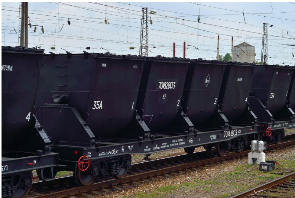
Рисунок 3.1 – Спеціалізований вагон моделі 17-494 для перевезення бітуму
