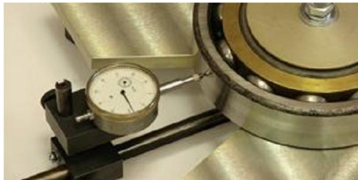
Рисунок 1.8 – Пристрій для вимірювання радіального зазору підшипників кочення
