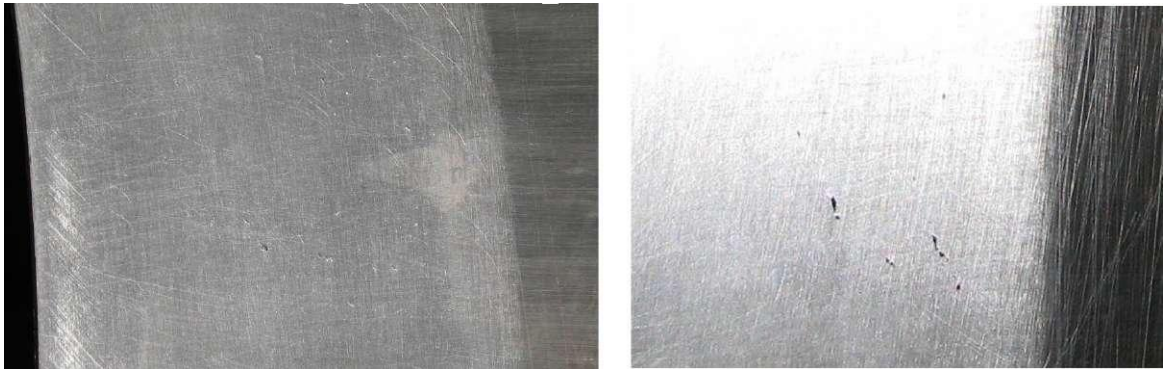
Рисунок 1.7 - Раковини на біговій доріжці зовнішнього кільця дворядного роликового підшипника
