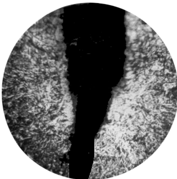
Рисунок 5.8 – Знеуглецьований шар по краям тріщини ( \times 250 )
