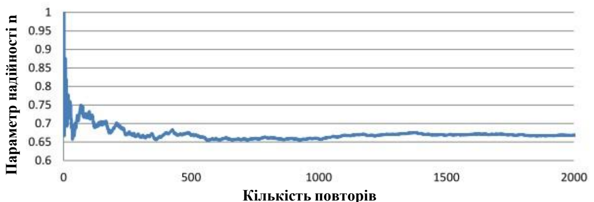
Рисунок 4.4 – Графік параметра надійності (ймовірності працездатності) реакторного блоку до оптимізації: по вісі ОУ – параметр надійності n ; по вісі ОХ – кількість повторень
