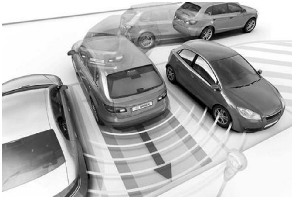
Рисунок 1.4 - Застосування ультразвукових датчиків в системі парковки
