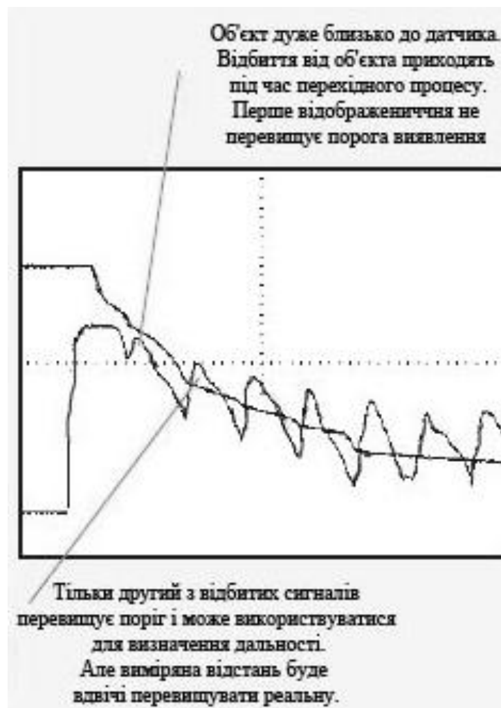
Рисунок 2.6 – Ефект багатократних віддзеркалень при знаходженні об'єкта в «сліпій» зоні
