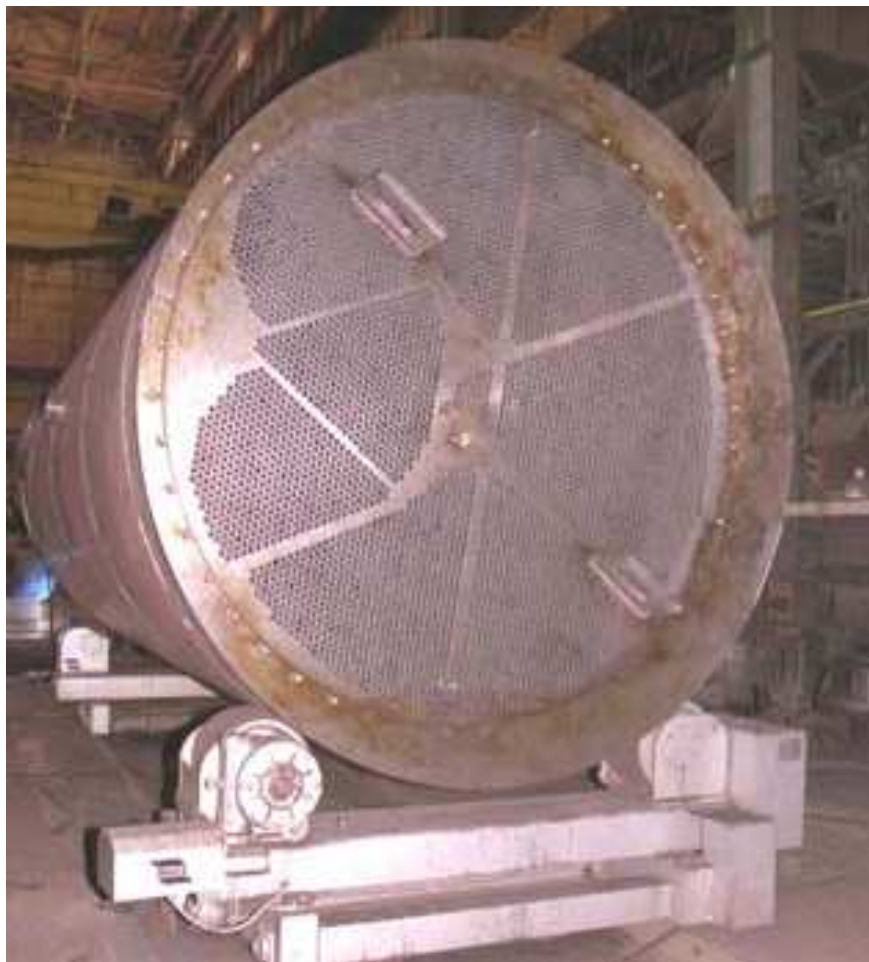
Рисунок 6.6 - Роликові кантувальні пристрої для збирання та зварювання циліндричних обичайок
