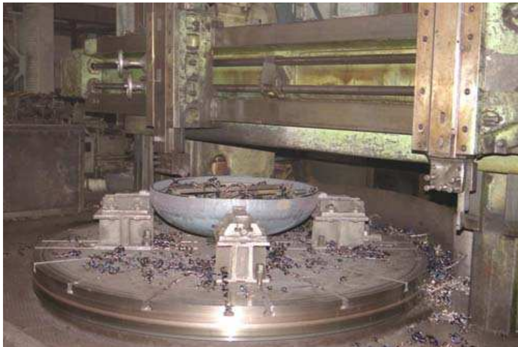
Рисунок 6.8 - Механічна обробка випуклого днища
