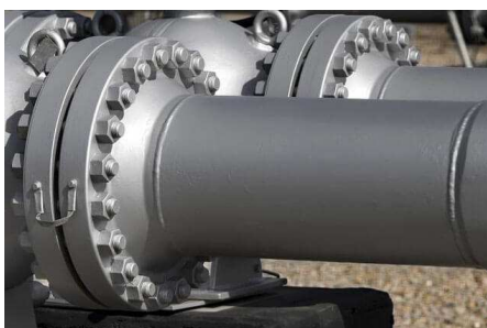
Рисунок 6.10 – Плоскі приварні фланці
