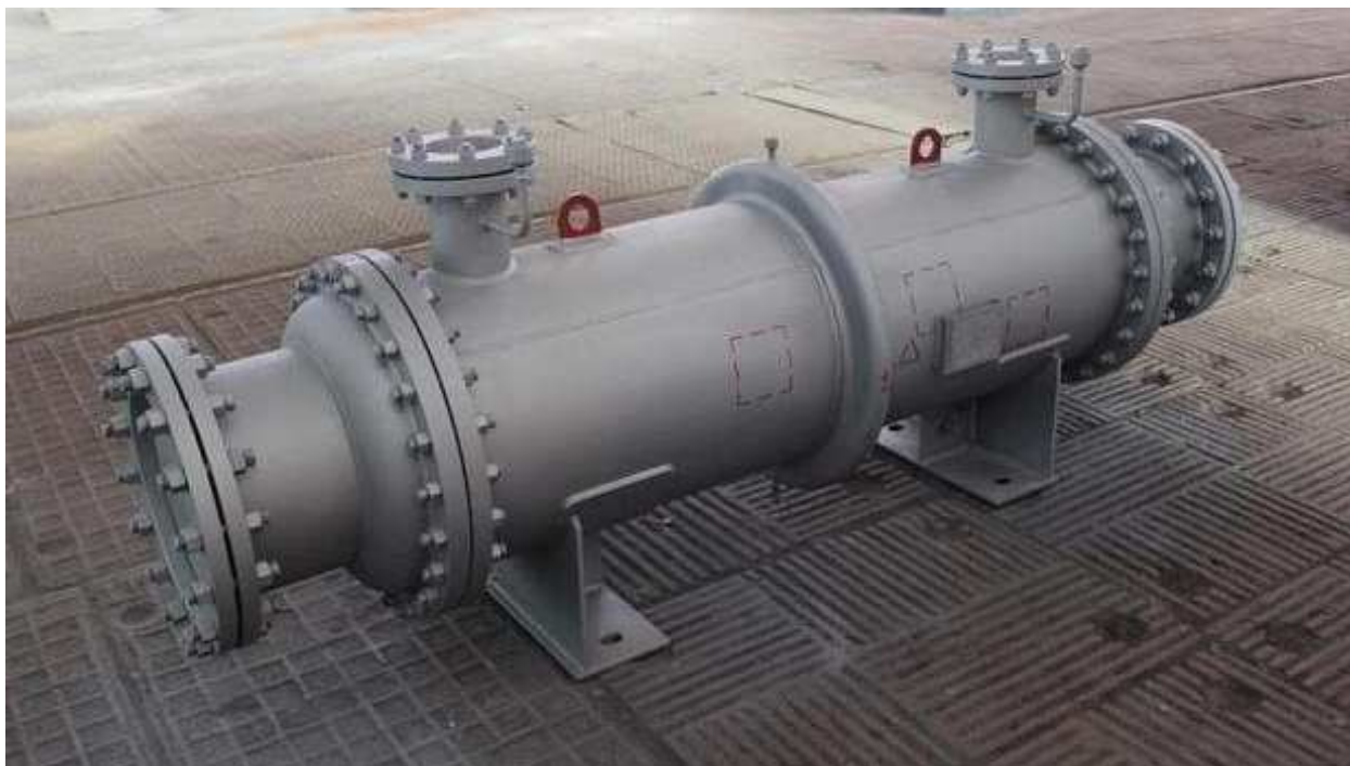
Рисунок 6.12 – Горизонтальний теплообмінник на сідлових опорах Виготовлення трубних решіток (рис. 6.13) полягає в наступному:
