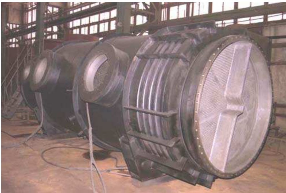
Рис. 9.17. Горизонтальний підігрівач мережевої води на сідлових опорах
