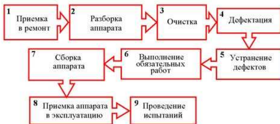
Рис. 11.3. Схема технологічного процесу, відповідного стратегії ремонту з напрацювання
