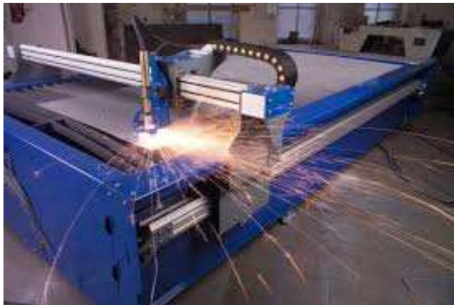
Мал. 9.6. Газове різання листової заготовки
