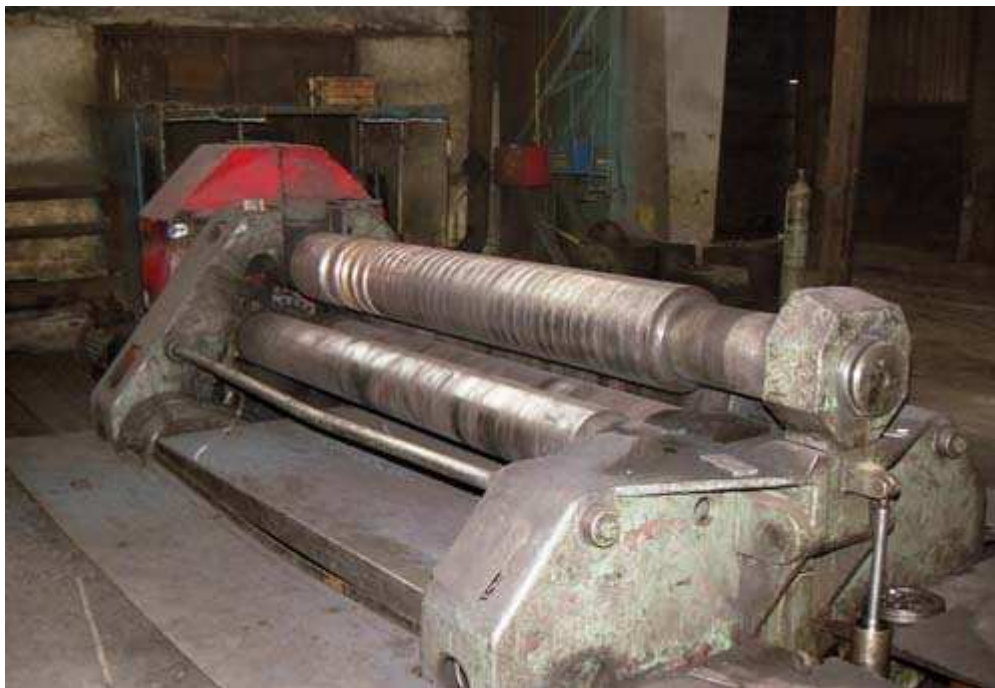
Рис. 9.9. Схема гнучкі аркушів на листозгинальних вальцях.
