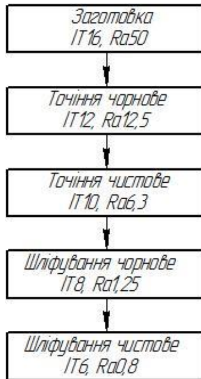
Рисунок 4.1 – Етапи та види обробки поверхні \varnothing 25js6
