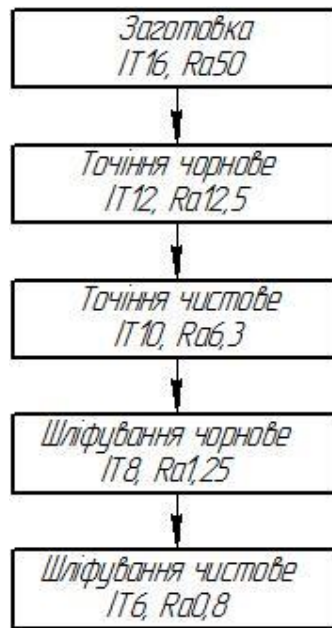
Рис. 13 – Етапи та види обробки поверхні \varnothing 40k66
