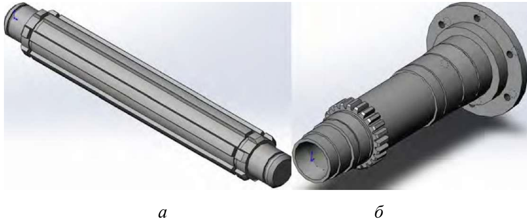
Рисунок 4.8 - Тривимірні моделі валів: а - І-й вал; б - шпиндель
