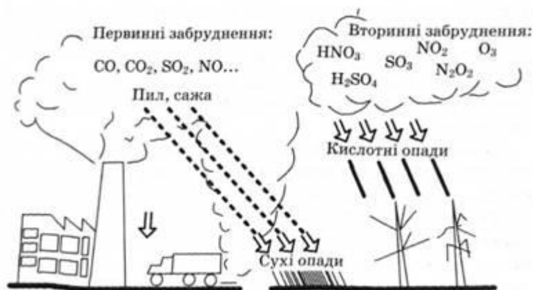
Рис. 4.1. Спрощена схема утворення кислотних опадів
