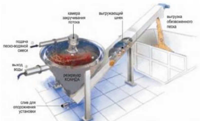
Рис.4.8 - Принципова схемі відмивання піску в гідроциклонній установці
