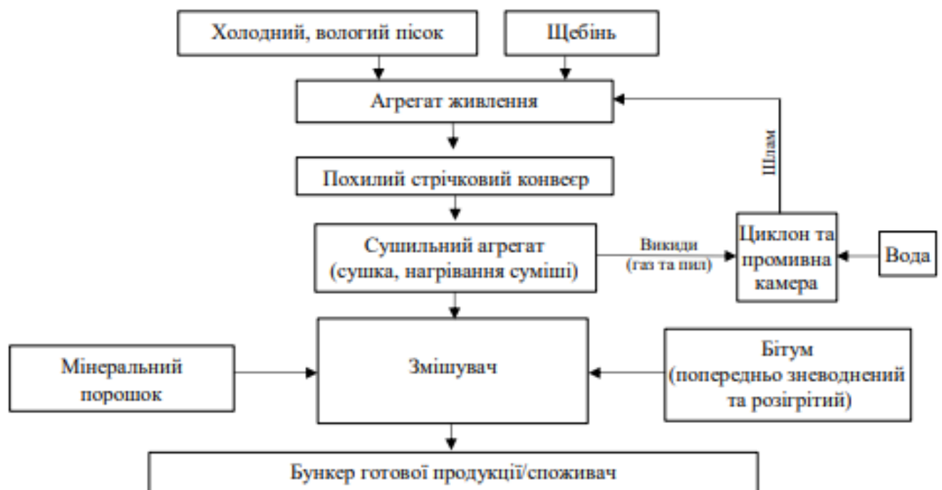
Рисунок 4.1– Схема технологічного процесу виготовлення асфальтобетонної суміші
