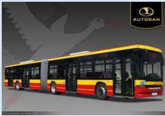
Рис. 24. Автобус Ansity 18LF Мест для сидения – 34-49. Пассажировместимость – 180. Двигатель: IVECO EEV
