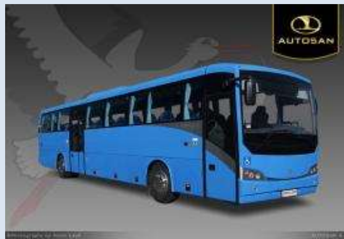
Рис. 30. Междугородный автобус EuroLider 13 Мест для сидения – 59. Пассажировместимость – 95. Двигатель: Cummins EURO5
