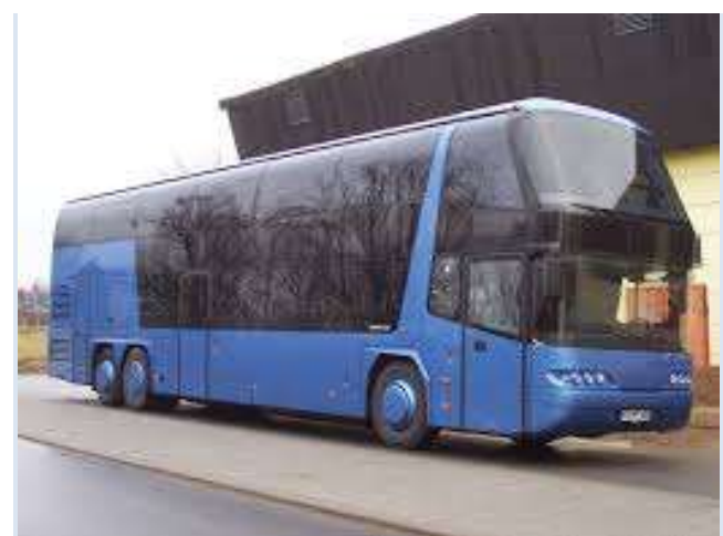
Рис. 36. Трехосные двухэтажные лайнеры Neoplan Skyliner C для перевозки большого количества пассажиров, имеющие очень высокий комфорт перевозки.
