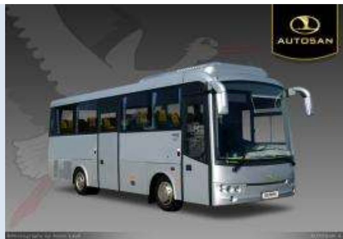
Рис. 28. Междугородный автобус Gemini Мест для сидения – 33. Пассажировместимость – 43. Двигатель: Cummins EURO5
