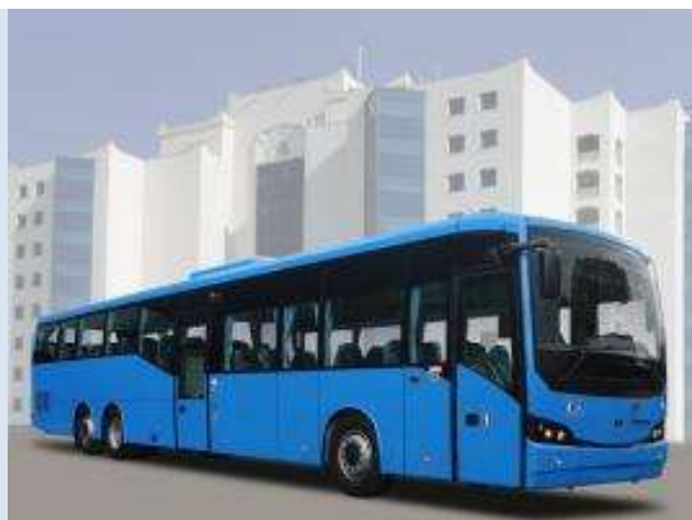
Рис. 26. Пригородный автобус EuroLider 15LE Мест для сидения – 44-65. Пассажировместимость – 98-120. Двигатель: DAF EEV
