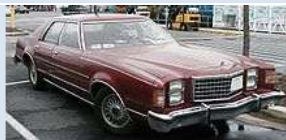
Рис. 21. Ford LTD II 1977-79 годов при длине 5 470-5 580 мм считался среднеразмерным, так как полноразмерный Ford LTD имел ещё большие габариты – длина 5690-5730 мм.
