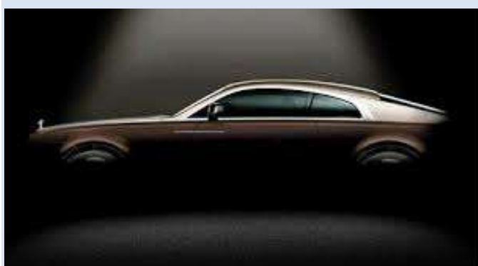
Рис. 16. Фастбэк – автомобильный кузов, имеющих особую покатую форму крыши
