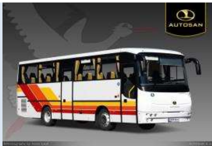
Рис. 29. Междугородный автобус Lider 9 eco Мест для сидения – 39. Пассажировместимость – 66. Двигатель: IVECO N60ENT
