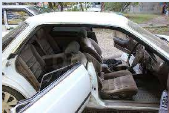
Рис. 12. Хардтоп-седан – кузов без средней стойки
