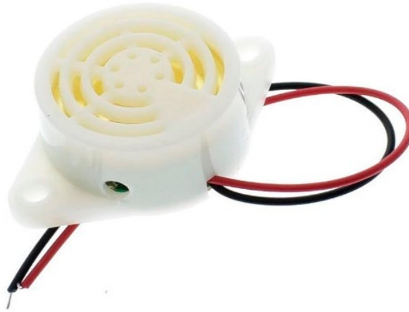
Рисунок 2.5 - Пьезокерамічний сигналізатор SFM - 27 95 дБ 3-24 В
