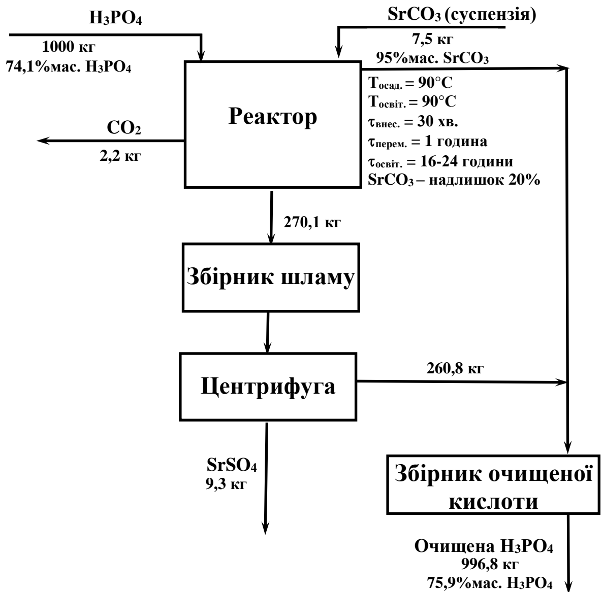
Рисунок 5.1 – Принципова технологічна схема знесульфачування екстракційної фосфатної кислоти карбонатом стронцію
