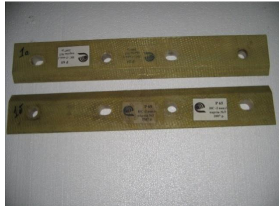
Рис.1.5 Повнотіла залізнична накладка (торцева прокладка не відображено).
