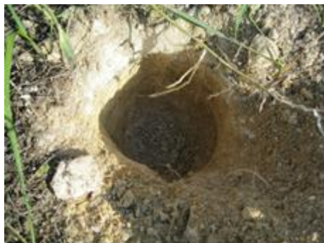
Рисунок 2.3 – Відбір проб шламу із накопичувача № 2 по глибині
