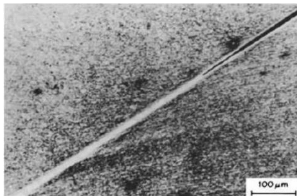
Рисунок 6.2 - Руйнування матеріалу уздовж смуги зсуву в сталі
