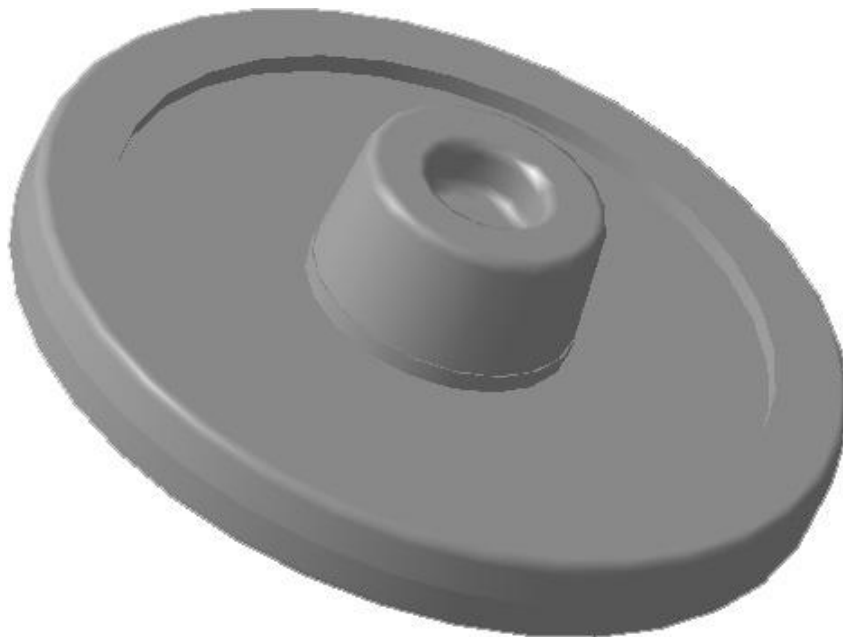
Рисунок 1.4 - Тривимірна модель заготовки
