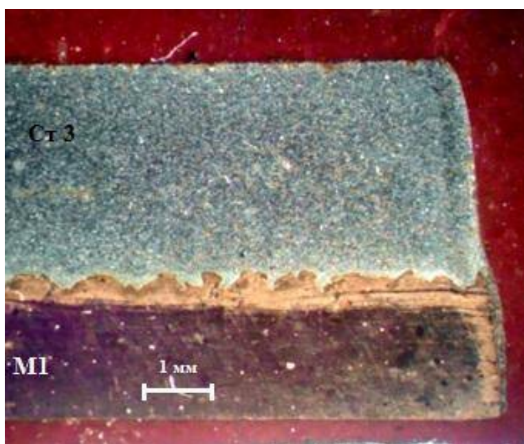
Рисунок 4.27 – Геометрія різа композиції «сталь Ст3 + мідь МІ» при расах-крої за технологічною схемою Ні – Focus plus ( I = 50 \text{ A} , V = 1,75 \text{ м/хв} ); різ з боку сталі Ст3
