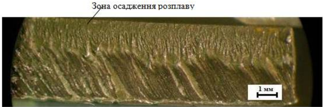
Рисунок 3.11 – Збільшення зони осадження розплаву на поверхні різання неіржавіючої сталі 12X18H10T при зменшенні струму і швидкості різання ( I = 26 \text{ A} , V = 0,9 \text{ м/хв} )
