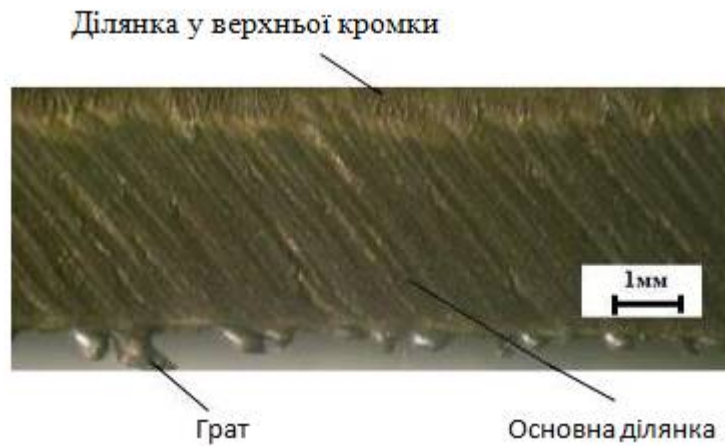
Рисунок 3.10 – Зовнішній вигляд поверхні різа неіржавіючої сталі 12X18H10T після тонкоструйного плазмового різання ( I = 30 А, V = 1,3 м/хв)
