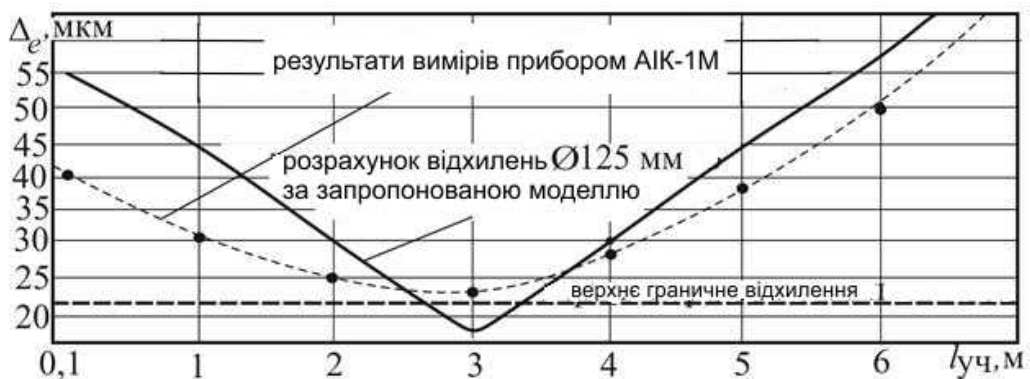
Рисунок 3.6 - Порівняння теоретичних та експериментальних даних величини відхилень \Delta_e поздовжнього профілю отвору.
