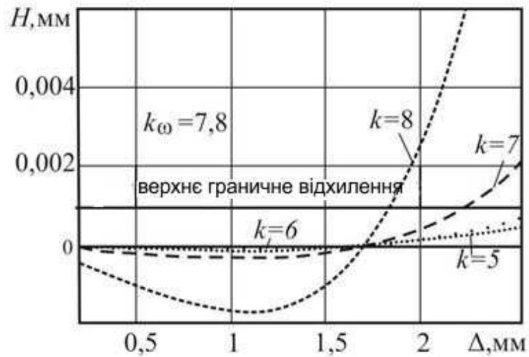
Рисунок 2.9 - Залежність величини H огранки глибокого отвору від відхилення від прямолінійності осі отвору заготовки при значеннях k близьких до k_\omega = 7,8
