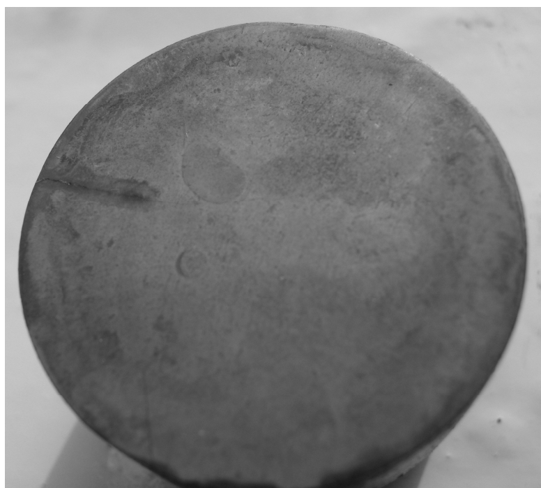
Рисунок 5.5 – Вид тріщини на пружині після травлення у реактиві Гейна
