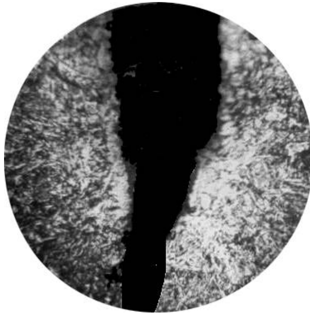
Рисунок 5.8 – Зневуглецьований шар у краю тріщини на пружині ( \times 250 )
