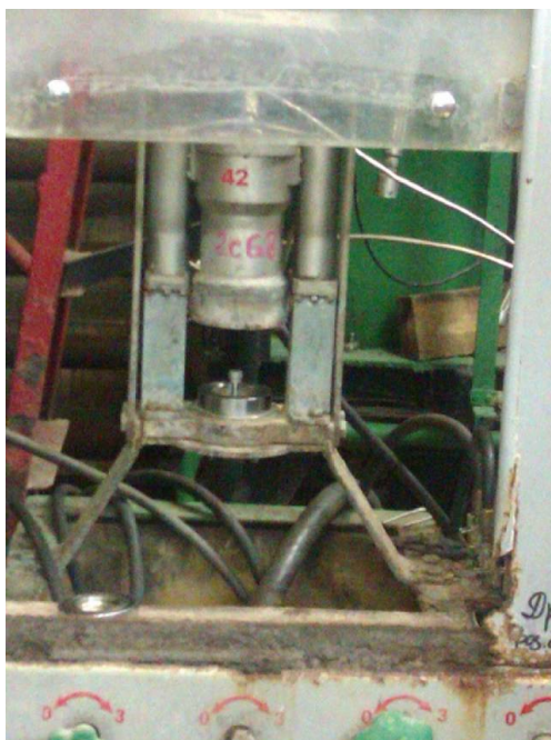
Рисунок 4.2 - Робоча зона стану для виміру витрати робочої рідини через проточні канали
