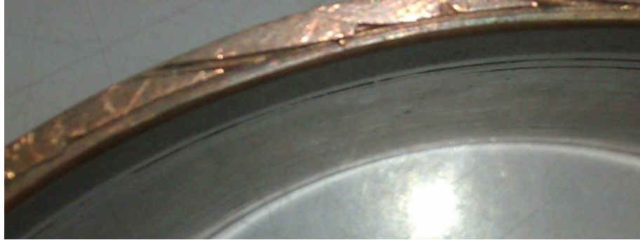
Рисунок 1.3 - Фрагмент охолоджувальної оболонки з тангенціальними каналами оболонки
