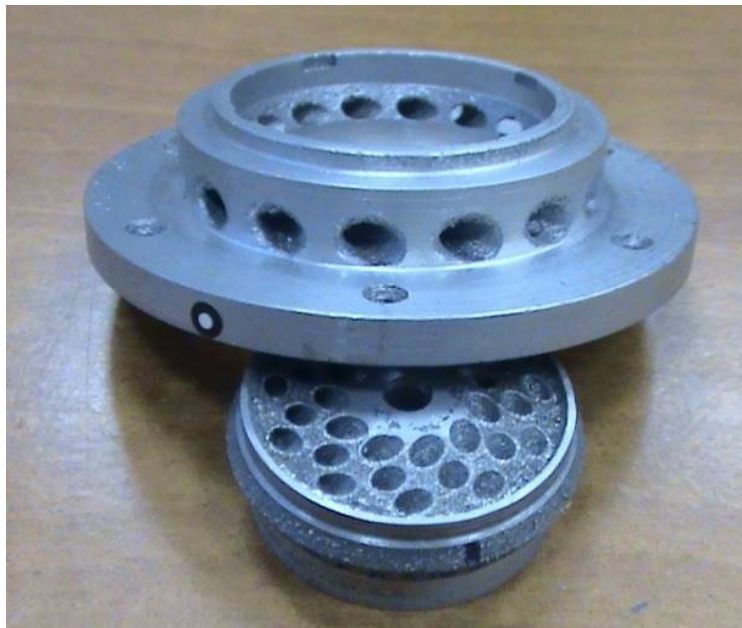
Рисунок 1.21 - Деталь з каналами отримана за допомогою адитивних технологій на 3D принтері
