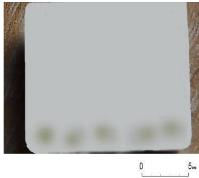
Рисунок 3.2 – Зображення лінійно-впорядкованої сукупності локальних елементів дифузійного покриття на передній поверхні ріжучої пластини
