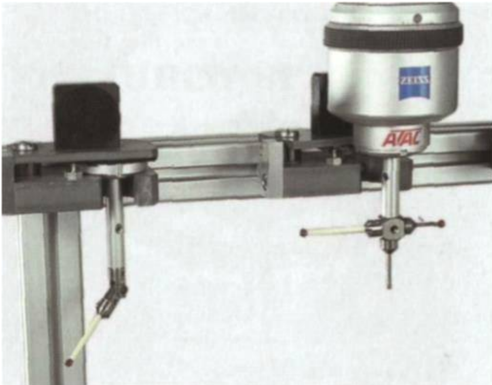
Рисунок 1.3 – Щуп з п'єзоелектричним датчиком і системою заміни наконечників
