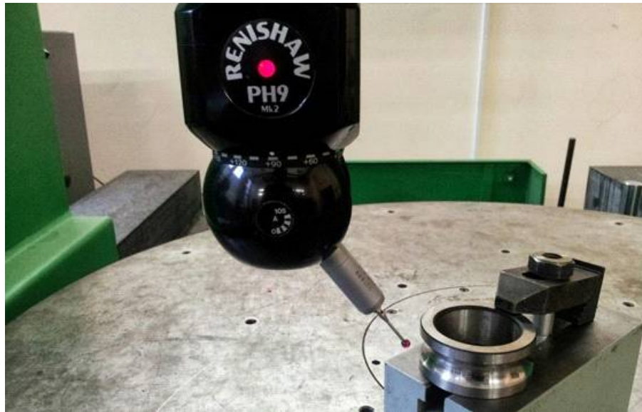
Рисунок 4.4 - Вимірювання внутрішнього кільця підшипника 307А
