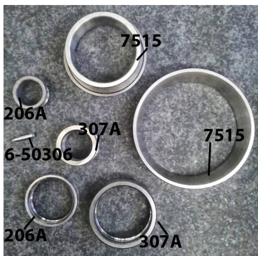
Рисунок 4.2 – Кільця підшипників 206А, 307А, 7515 и № 6-50306
