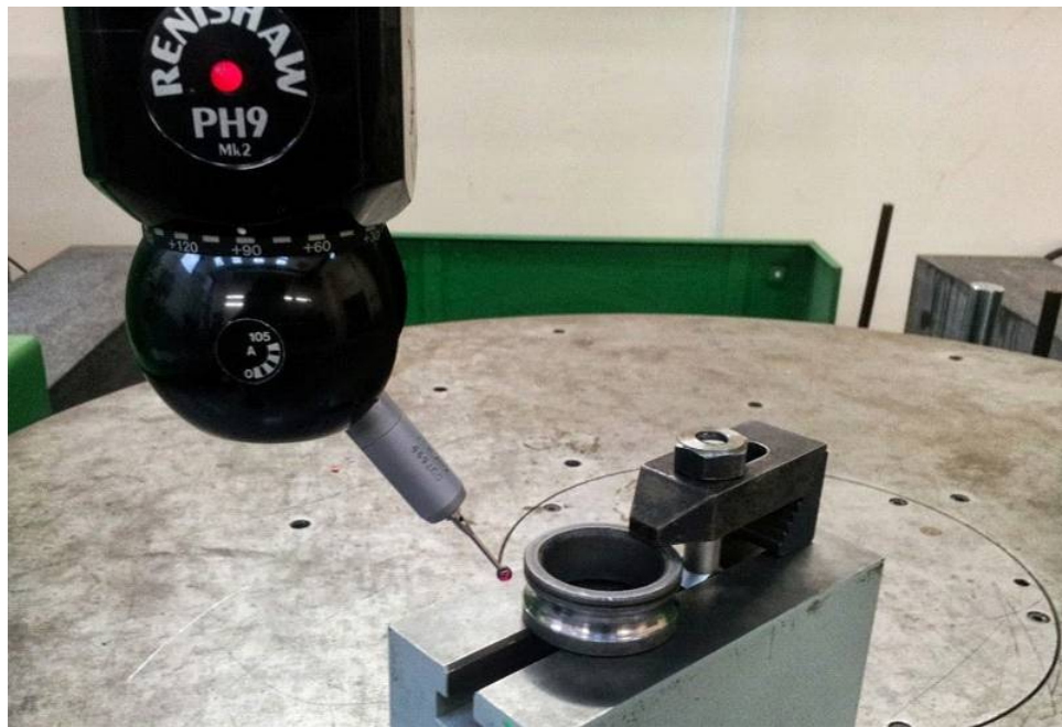
Рисунок 4.12 - Вимірювання внутрішнього кільця підшипника 206А
