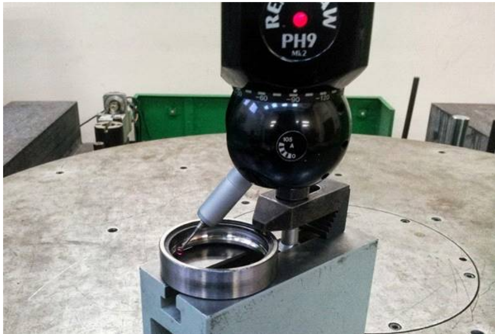
Рисунок 4.15 - Вимірювання зовнішнього кільця підшипника 206А
