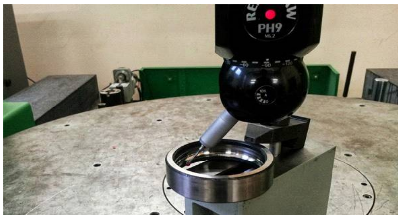
Рисунок 4.7 – Вимірювання зовнішнього кільця підшипника 307а
