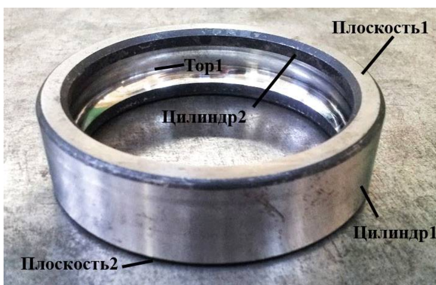
Рисунок 4.9 - Геометричні об'єкти, виміряні на кільці підшипника
