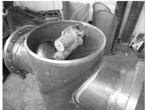
г) корпус перед прихваткою кришки (зменшення овальності за допомогою домкрата)
