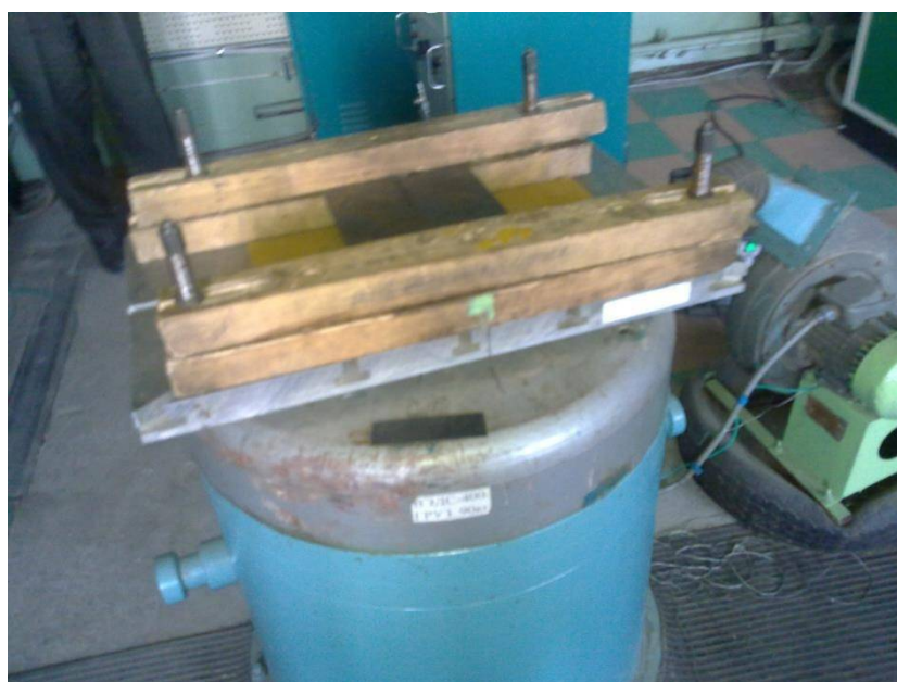
Рисунок 4.1 - Фото зразка закріпленого на вибростенді перед зварюванням
