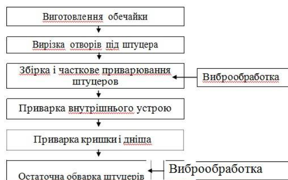
Рисунок 5.4 - Схема вдосконаленого маршруту виготовлення корпусу фільтра
