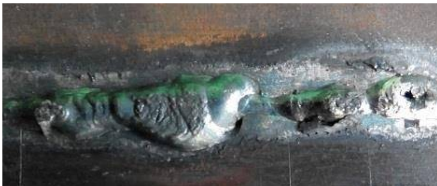
Рисунок 4.2 - Фото зразка з дефектом "прожог" (зварювання на частотно-модульованому режимі)
