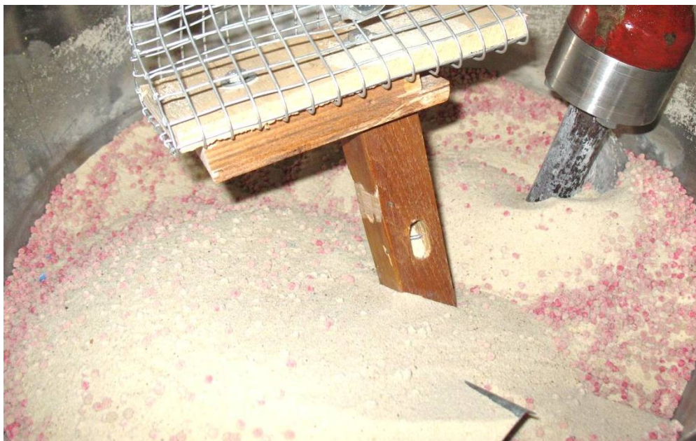
Рисунок 4.7 - Розподілення компонентів в змішувачі з двома додатковими розподільними елементами після 4 обертів водила
