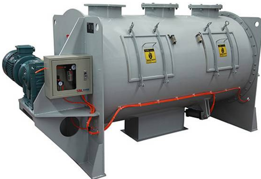
Рисунок 1.5 - Плужной змішувач фірми SHUANGLONG GROUP [17]
