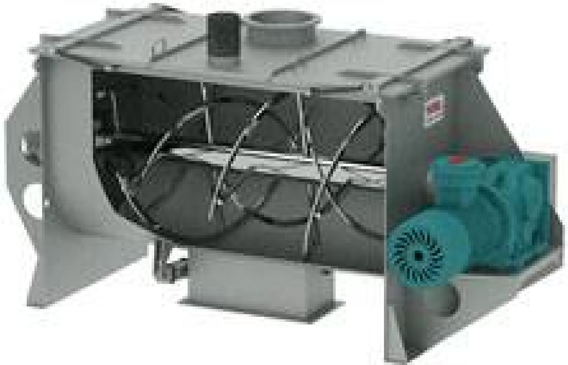
Рисунок 1.3 - Стрічковий змішувач фірми SHUANGLONG GROUP [17]
