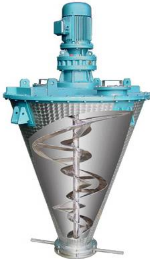
Рисунок 1.8. - Конічний стрічковий змішувач фірми SHUANGLONG GROUP [17]
