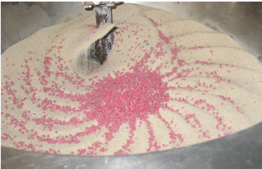
Рисунок 4.5 - Змішування без додаткового розподільного елемента після 6 обертів водила
