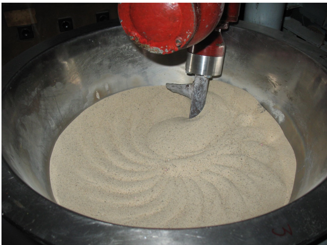
Рисунок 4.5 - Поверхня матеріалу після 12 обертів водила.
