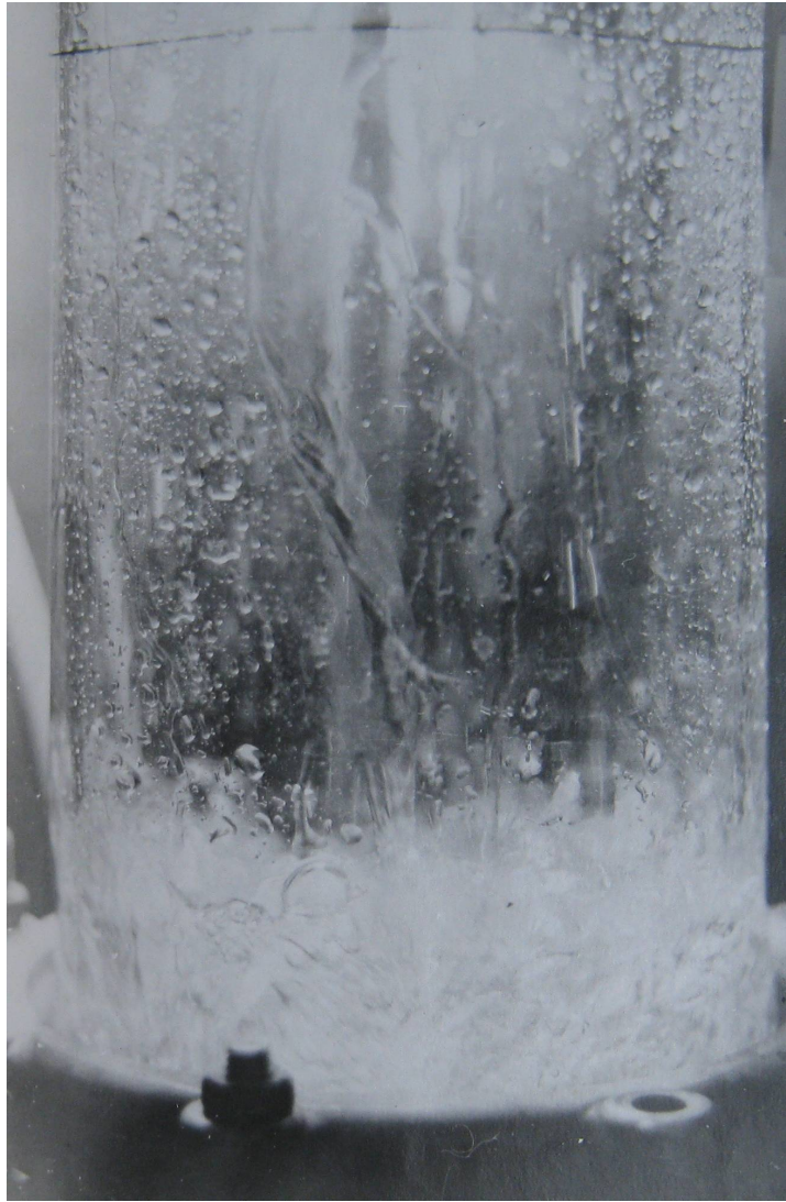
Рисунок 14 – Робота тарілки провального типу в режимі однорідного барботажного шару: тарілка № 10 (таблиця 1),
