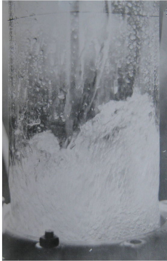
Рисунок 15 – Робота тарілки провального типу в режимі рухомого газорідинного шару: тарілка № 10 (таблиця 10),
