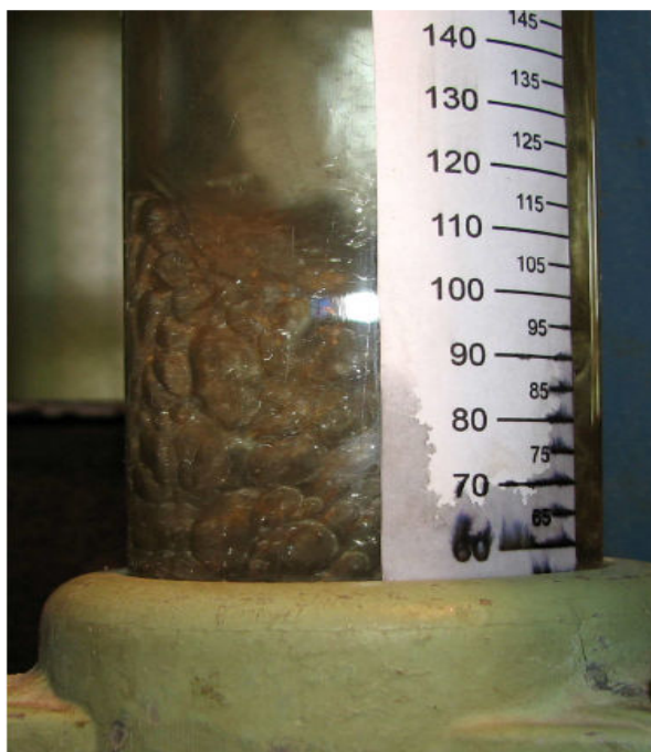
Рисунок 2.2 - Робота тарілки провального типу в режимі однорідного барботажного шару: тарілка № 21 (таблиця 2.1), L = 13,5 \text{ м}^3/(\text{м}^2 \cdot \text{год}) , w = 0,56 \text{ м/с} .
