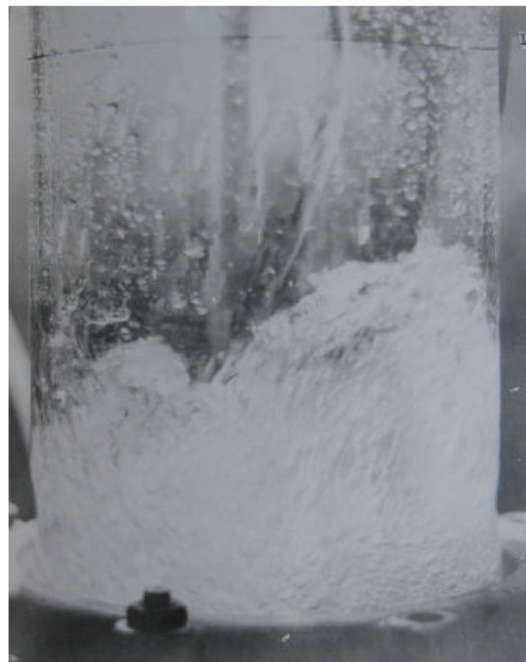
Рисунок 2.5 - Робота тарілки провального типу в режимі рухомого газорідинного шару: тарілка № 10 (таблиця 2.1), L = 12,7 \text{ м}^3/(\text{м}^2 \cdot \text{год}) , w = 0,83 \text{ м/с} .
