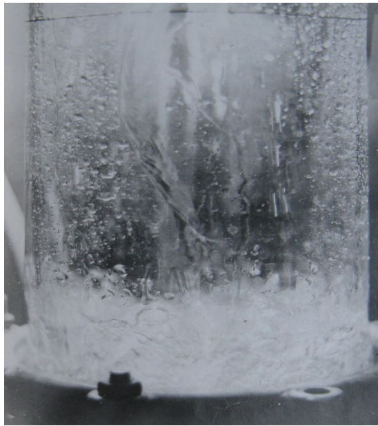
Рисунок 2.4 - Робота тарілки провального типу в режимі однорідного барботажного шару: тарілка № 10 (таблиця 2.1), L = 12,7 \text{ м}^3/(\text{м}^2 \cdot \text{год}) , w = 0,72 \text{ м/с} .
