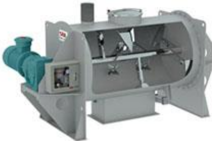
Рисунок 1.10 - Плужні змішувачі фірми SHUANGLONG GROUP (Китай) [16]. а) Зовнішній вигляд. б) Ротор
