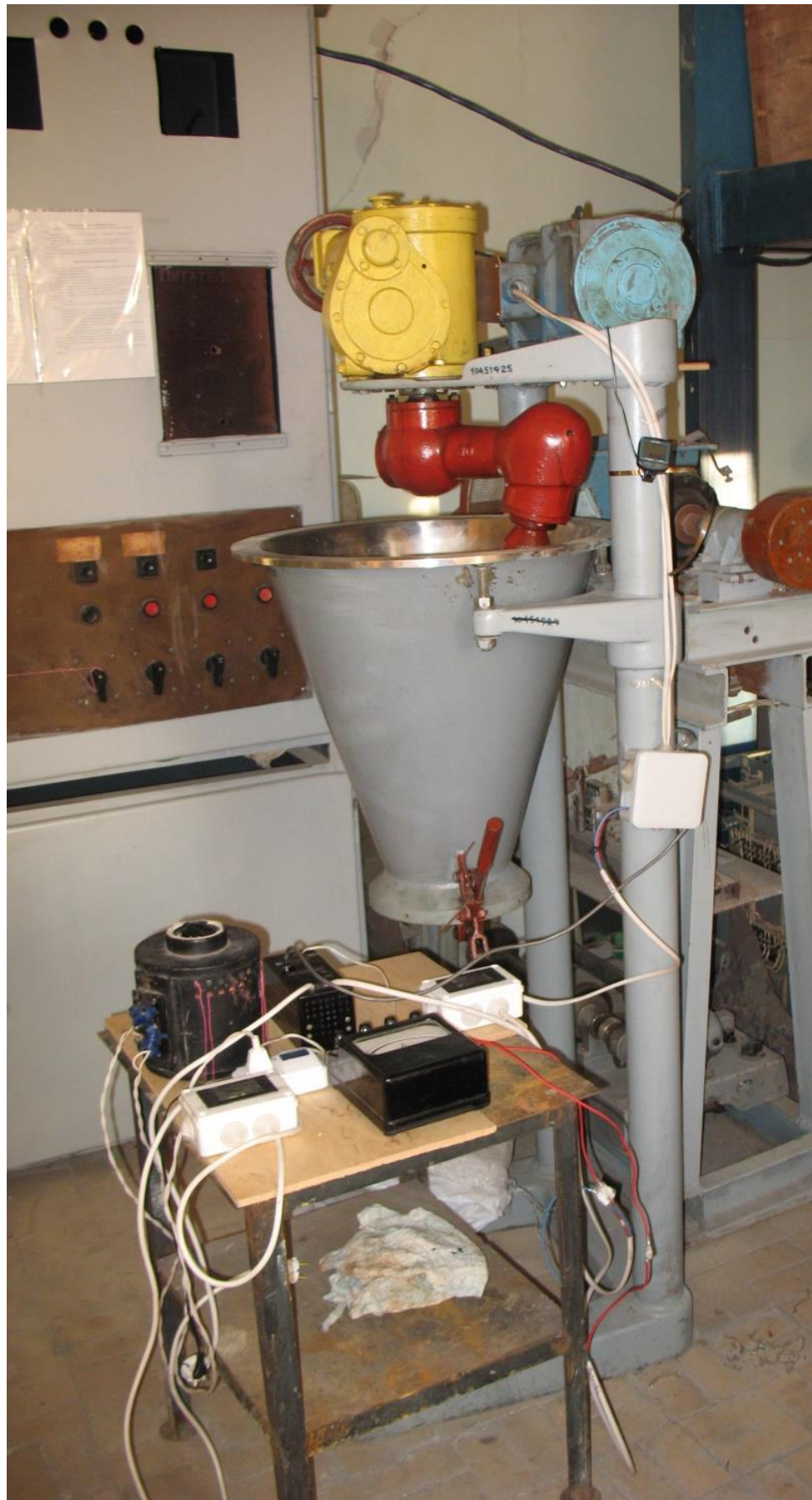
Рисунок 3.1 - Змішувач ПШ-24 (модернізований планетарно-шнековий змішувач фірми «Nauta» (Нідерланди).
