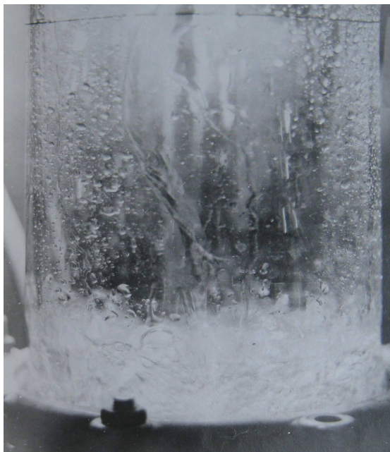
Рисунок 9 - Робота тарілки провального типу в режимі однорідного барботажного шару: тарілка № 10, L = 12,7 \text{ м}^3/(\text{м}^2 \cdot \text{год}) , w = 0,72 \text{ м/с} .
