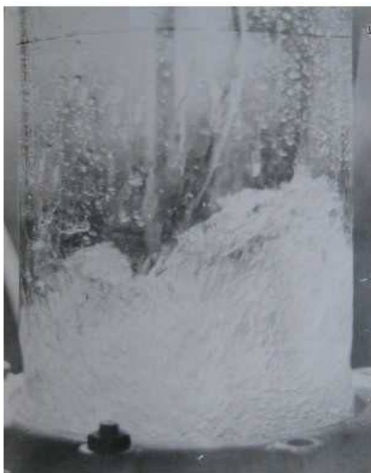
Рисунок 10 - Робота тарілки провального типу в режимі рухомого газорідного шару: тарілка № 10, L = 12,7 \text{ м}^3/(\text{м}^2 \cdot \text{год}) , w = 0,83 \text{ м/с} .
