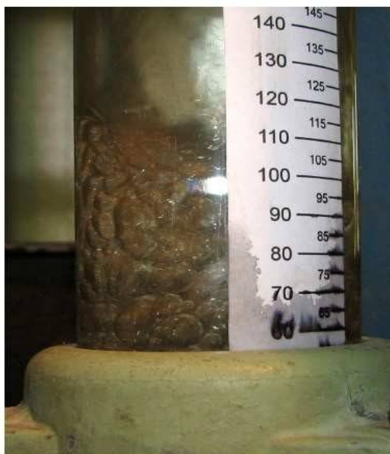
Рисунок 7 - Робота тарілки провального типу в режимі однорідного барботажного шару: тарілка № 21 (таблиця 10), L = 13,5 м 3 /(м 2 •год), w = 0,56 м/с.
