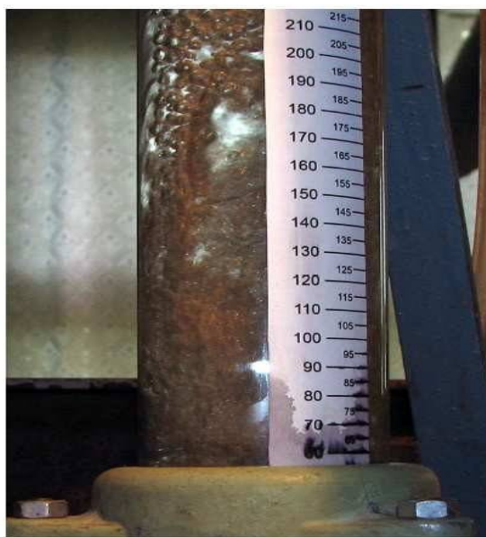
Рисунок 8 - Робота тарілки провального типу в режимі рухомого газорідного шару: тарілка № 21 L = 13,5 м 3 /(м 2 •год), w = 1,44 м/с
