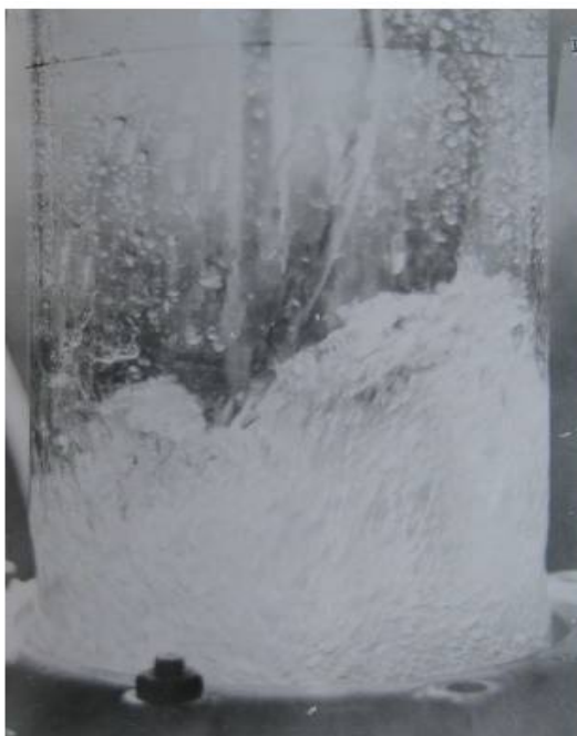
Рисунок 3.3 - Робота тарілки провального типу в режимі рухомого газорідного шару: тарілка № 10 (таблиця 10), L = 12,7 \text{ м}^3/(\text{м}^2 \cdot \text{год}) , w = 0,83 \text{ м/с} .
