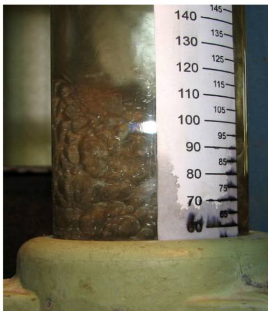
Рисунок 3 - Робота тарілки провального типу в режимі однорідного барботажного шару: тарілка № 21 (таблиця 10), L = 13,5 \text{ м}^3/(\text{м}^2 \cdot \text{год}) , w = 0,56 \text{ м/с} .
