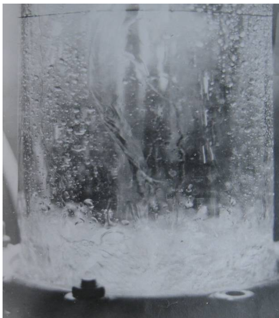
Рисунок 3.2 - Робота тарілки провального типу в режимі однорідного барботажного шару: тарілка № 10 (таблиця 10), L = 12,7 \text{ м}^3/(\text{м}^2 \cdot \text{год}) , w = 0,72 \text{ м/с} .
